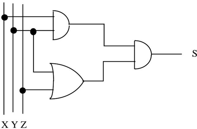
La porte ET supérieure nous donne X et Y la porte OU Y ou Z et les sorties de ces deux portes convergent dans la porte ET ce qui fait l'équation suivante:
