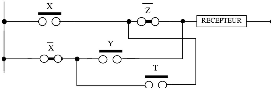
On trouvera les deux chemins directs comme précédemment, passant par  $X$  et  $\bar{Z}$  et par  $\bar{X}$  et  $\bar{Y}$  mais également deux autres passant par  $X$ ,  $T$  et  $Y$  ainsi que  $\bar{X}$ ,  $T$  et  $\bar{Z}$ . d'où l'équation:
