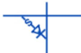
La seconde technologie utilise également des diodes mais au lieu d'éliminer les indésirables, il faut au contraire claquer un « anti-fusible » qui va sous l'effet d'une tension se court-circuiter et ainsi connecter la diode
